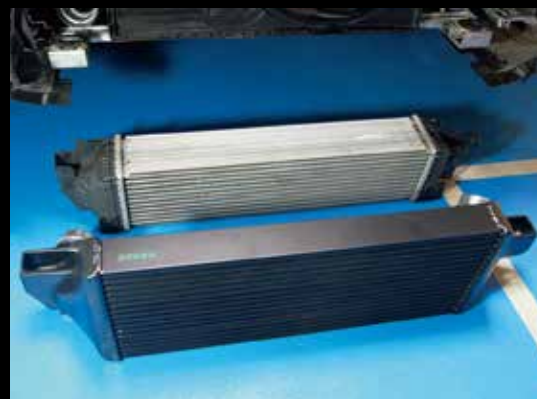
シルバーが純正インタークーラーで、ブラックがデクラ製インタークーラー。コアが幅広くなっているほか、後面のぶん、厚みも増している。それが冷却効率アップのポイントといえる部分だ。
