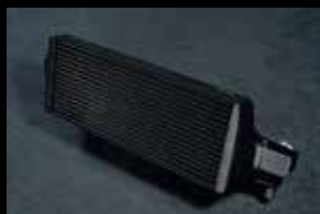
2層構造の後面段数を減らしてボディにフィットさせている。製造の工数は大幅に増えるが、冷却効率面からこの形状が採用されている。
