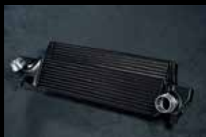
2層構造の後面段数を減らしてボディにフィットさせている。製造の工数は大幅に増えるが、冷却効率面からこの形状が採用されている。
