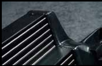
ターボチャージャーで圧縮された吸気は、インタークーラー内部で前面と後面に分離されて通路を通っていく。それによって冷やされることで充填効率向上。
