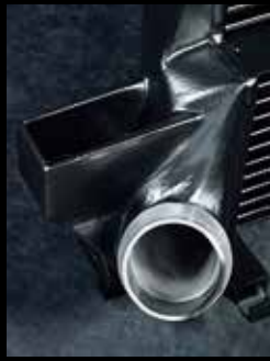
ターボチャージャーで圧縮された吸気は、インタークーラー内部で前面と後面に分離されて通路を通っていく。それによって冷やされることで充填効率向上。
