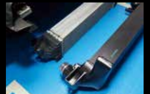
シルバーが純正インタークーラーで、ブラックがデクラ製インタークーラー。コアが幅広くなっているほか、後面のぶん、厚みも増している。それが冷却効率アップのポイントといえる部分だ。
